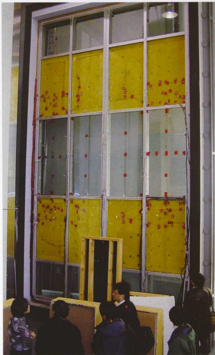
Pleine hauteur d'un spécimen de mur rideau à côté d'un caisson climatique. Les visiteurs japonais à l'avant examinent le spécimen de mur rideau de deux étages mis à l'essai dans le caisson climatique de l'Université Concordia par Hua Ge, dans le cadre de son projet de doctorat.
