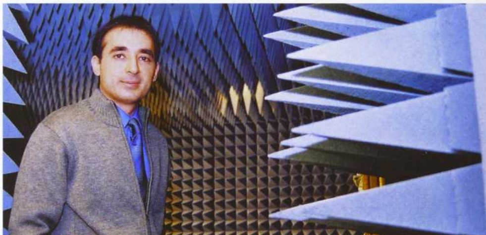
Chambre anéchoïque pour la caractérisation et la validation, dans un environnement isolé, de nouvelles antennes pour les futures communications sans fil du laboratoire radio-fréquence à l'INRS.
