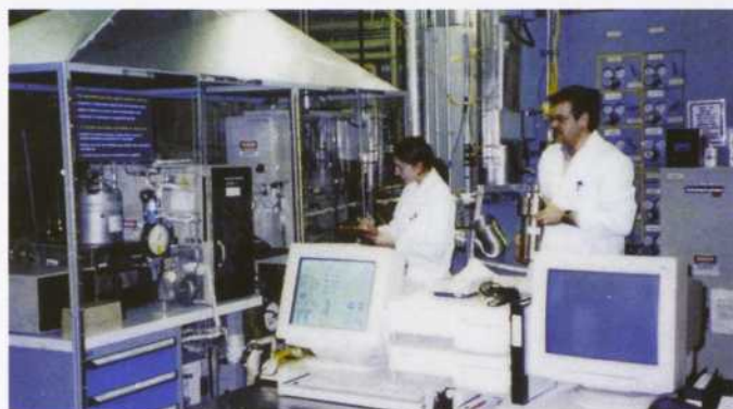
Réacteur semi-pilote utilisé pour tester les catalyseurs de cracking, au centre des technologies de l'énergie CANMET.
