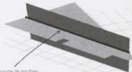
La combinaison des fonctions PlanarFrame (charpente) et FloorAssembly (plancher) crée Beams (poutres).
