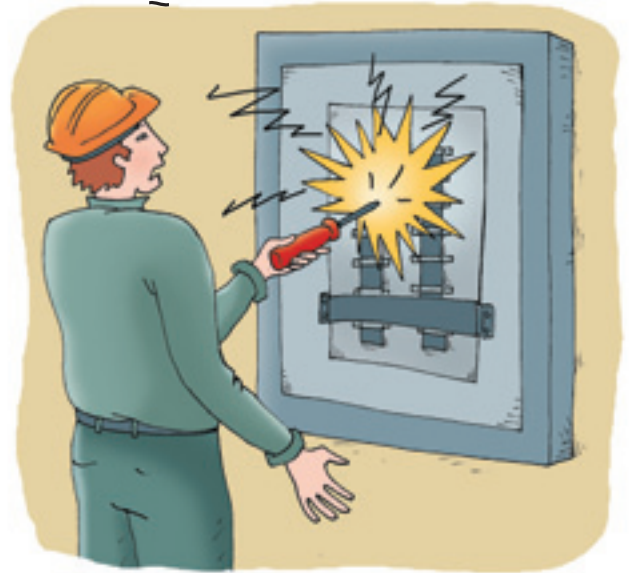
Le tournevis glisse et crée un court-circuit qui provoque un arc électrique.
