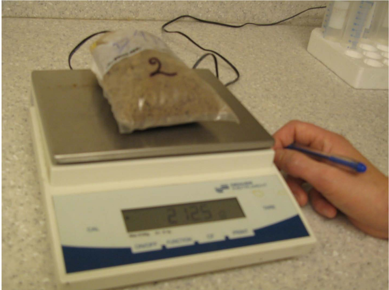
Figure 10. Humidité gravimétrique. Les échantillons sont pesés avant d'être séchés (humides) et après (secs). La différence entre les deux masses rapportées à la masse sèche de l'échantillon fournit le taux d'humidité des sols au moment des prélèvements.
