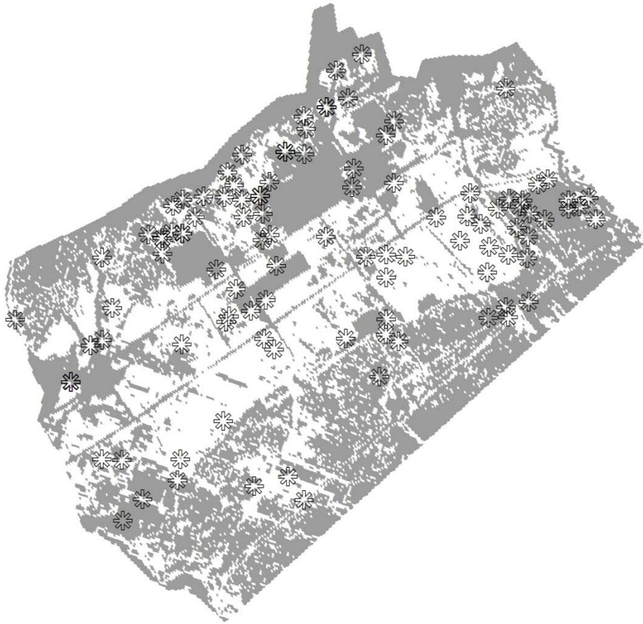
Figure 34. Localisation des anomalies en CO 2 et CH 4 observées (astérisques) et superposition aux anomalies prédites comme absentes (pixels gris) et présentes (pixels blancs).
