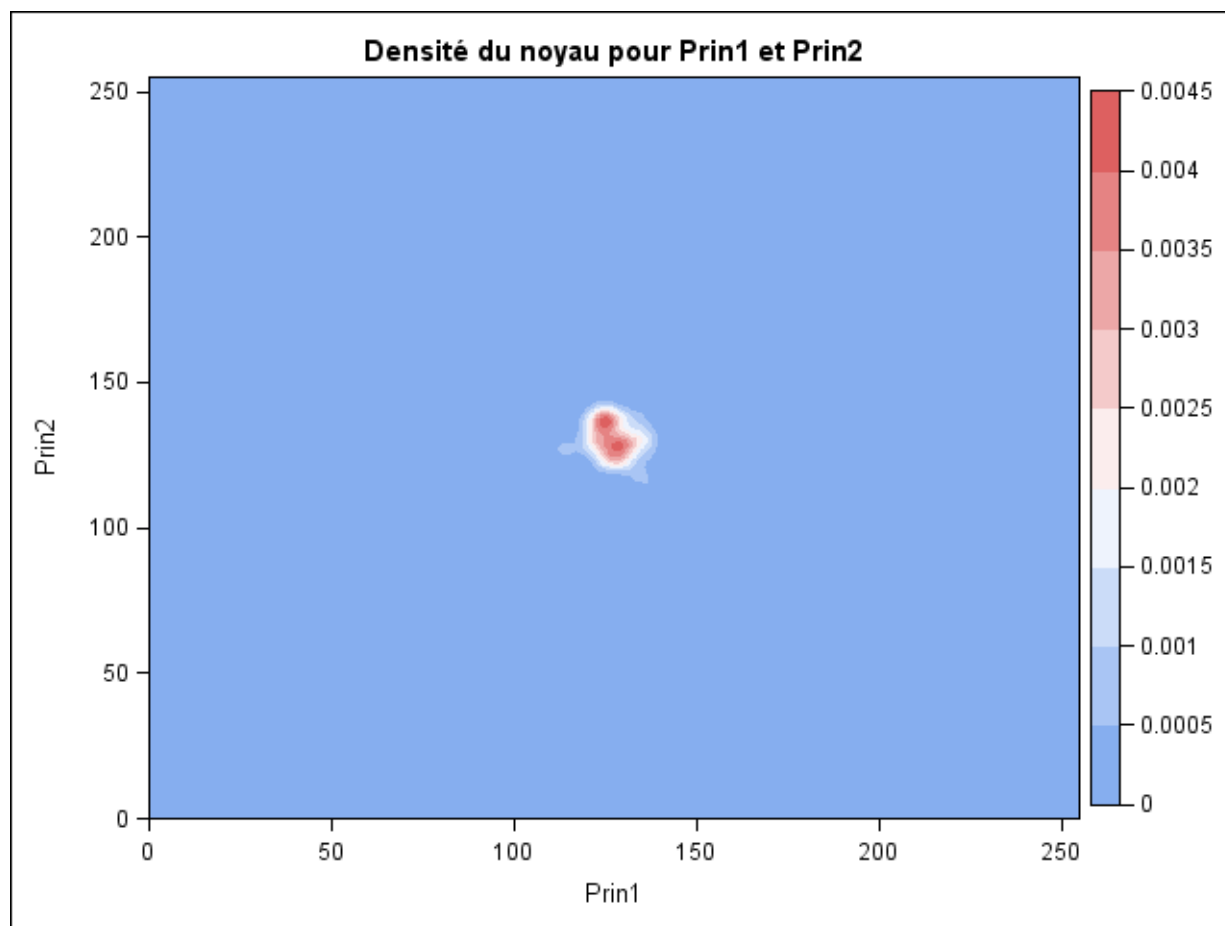
Figure 33. Représentation du kernel de densité pour les anomalies de CO 2 et de CH 4 en fonction des deux premières composantes de l'ACP effectuée sur les 7 bandes de l'image Landsat
