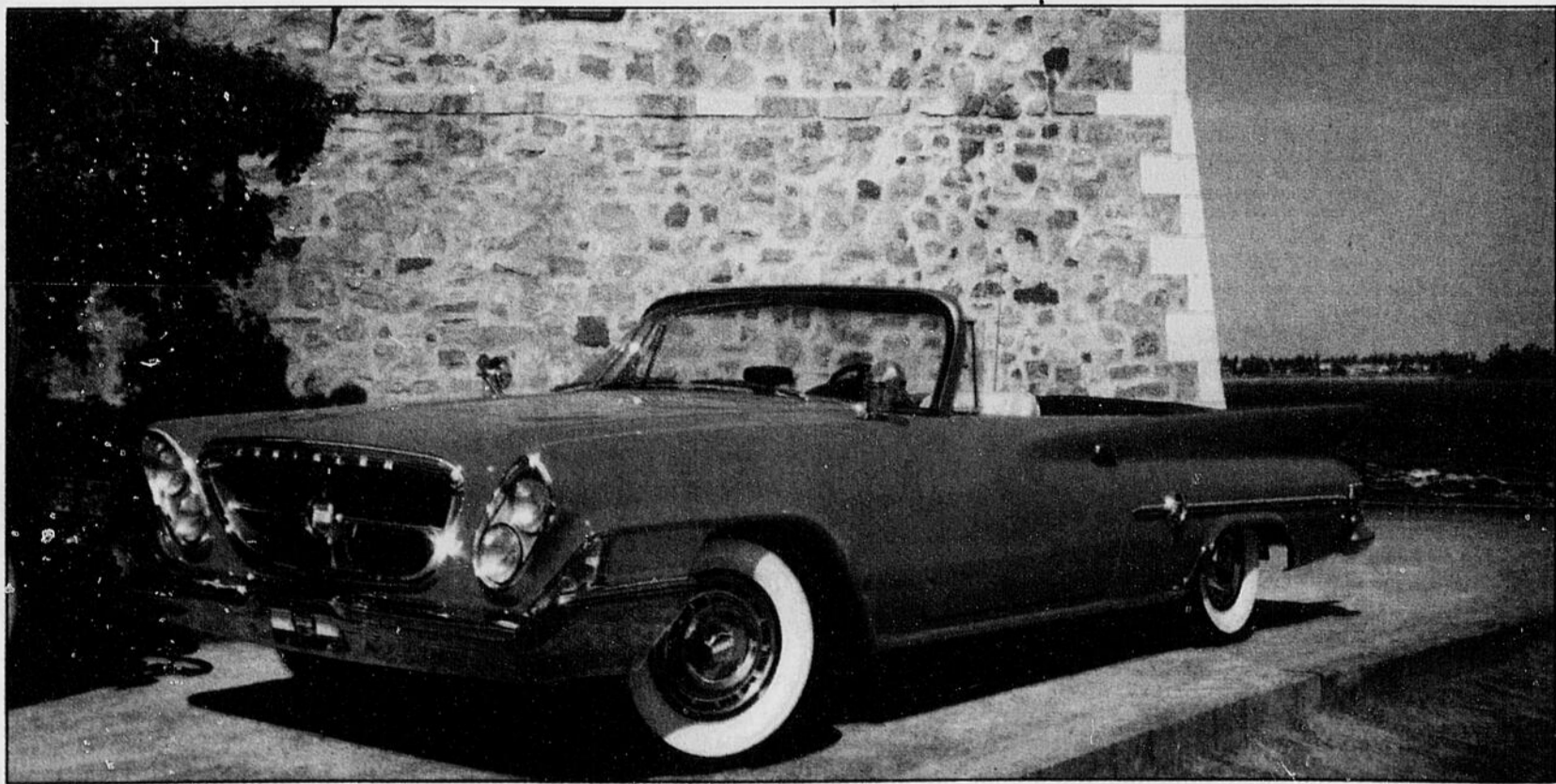
Cette Chrysler 1961 est un modèle 300G. Son moteur est un V8 cylindres, 413 pouces cubes, puissance 375 chevaux. Sa transmission est automatique 3 rapports, boutons presseurs. Prix à l'achat: 5841 $ US. Prix actuel: 46 000 $ US.
