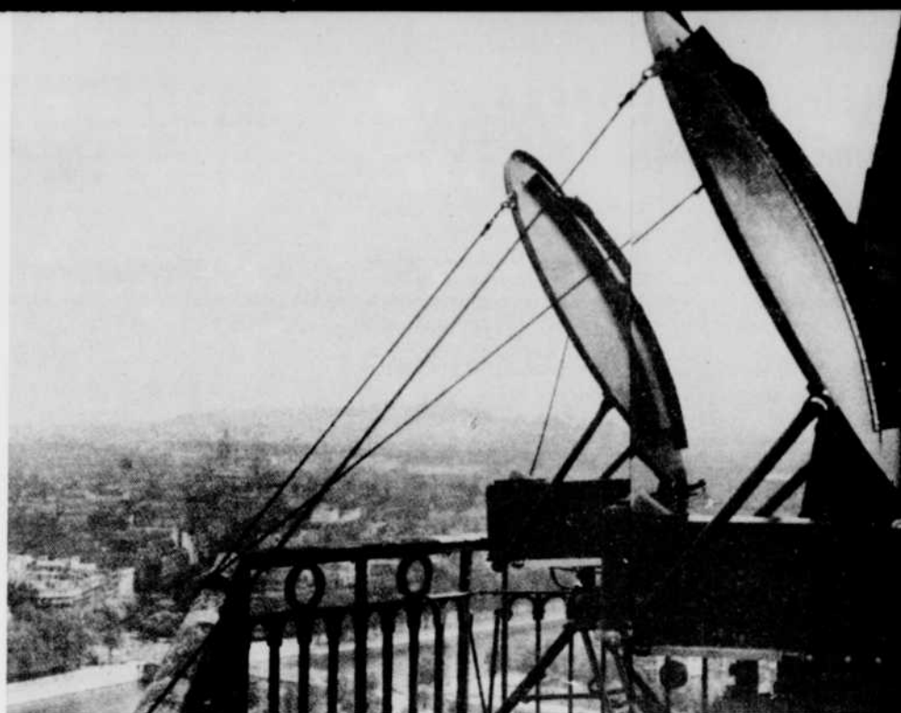
Fixés à la Tour Eiffel, deux récepteurs d'ondes métriques de la R.T.F.
