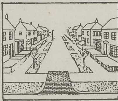
Exemple de design: entrées de rue en dos d'âne allongé et en goulot pour forcer le ralentissement et indiquer l'entrée d'une rue où des gens vivent; obstacles qui brisent la linéarité de la rue, limitant les possibilités d'accélération, et offrant de l'espace afin d'améliorer l'environnement urbain, tel la plantation d'arbres ou l'aménagement d'espaces publics. Dessins tirés de Zuckermann, Wolfgang. End of the road. The world car crisis and how can we solve it. 1991. 300 p.
