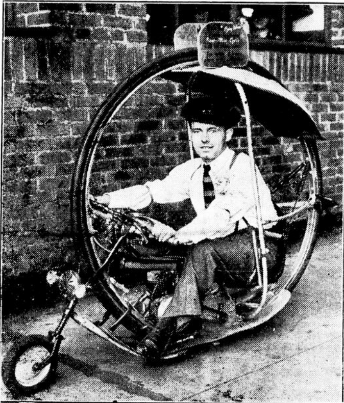
• "Roue Volante" c'est le nom donné à ce véhicule, par Julius Rose, mécanicien de Glendale, N. Y., qui prit quatre ans à le développer. Il fait 50 milles à l'heure.
