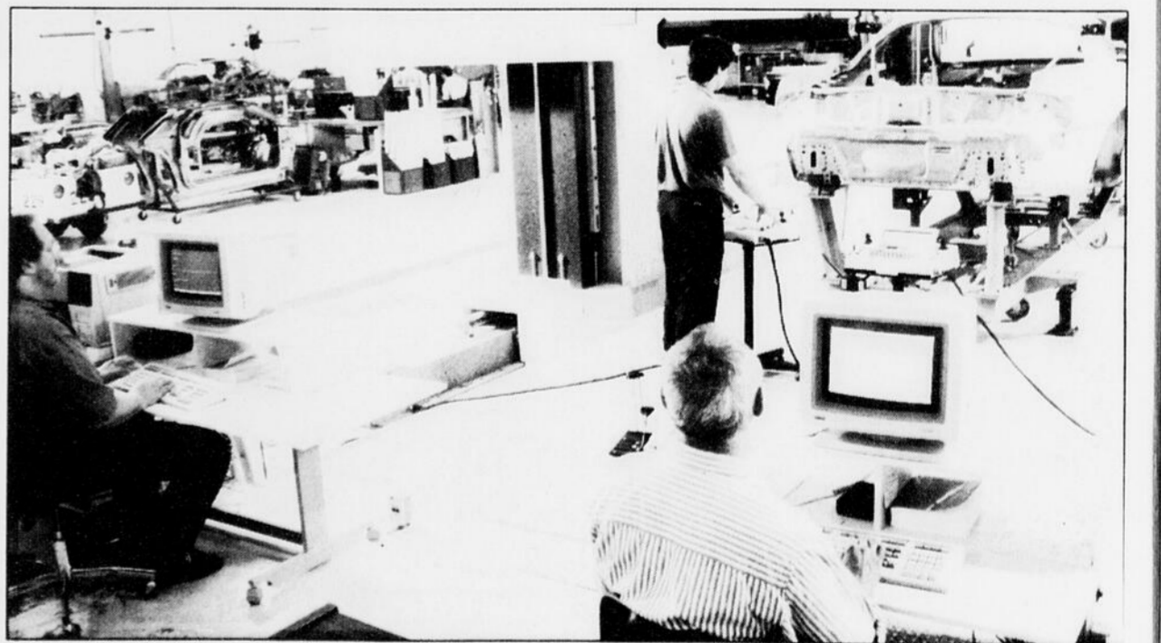
Construites à Boisbriand, au Québec, dans une usine fort moderne comparable au meilleur complexe d'assemblage du monde entier, ce duo de sportives fait avec raison notre fierté. Sur la photo, des techniciens se servent de l'appareillage de mesure en coordonnées qui prend des lectures de la dimension du véhicule afin de pouvoir établir la précision des procédés d'assemblage.
