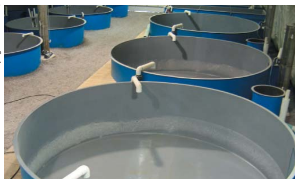
Aquaculture Nordik inc., bassins en fibre de verre de 70 m 3 de type « Cornell » de forme circulaire.
