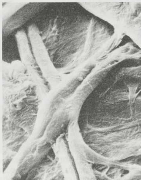
LES FIBRES DU PAPIER — La nature des fibres et leur orientation décident de l'usage qu'on fera du papier. Ici, la surface du papier est vue au microscope électronique (grossissement 1 500X). ▲
