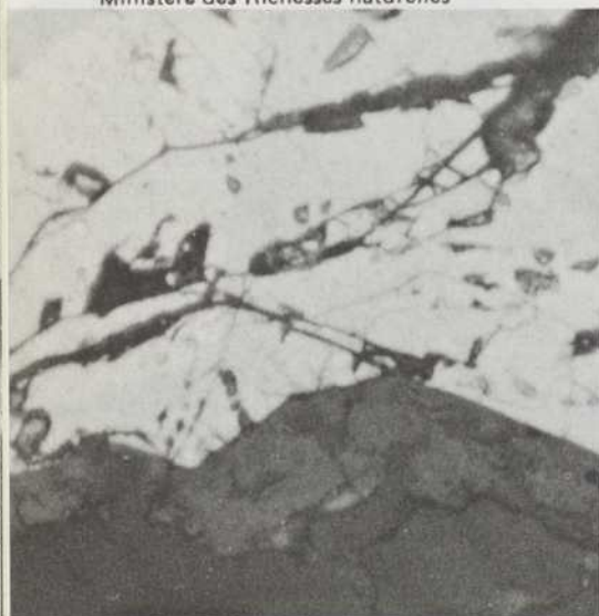
BARRIÈRE DE JAROSITE — Après quelques jours de lixiviation, la chalcopirite se recouvre de jarosite (croûte foncée) qui bloque la progression de l'oxydation. (Grossissement de 400 fois). ▲
