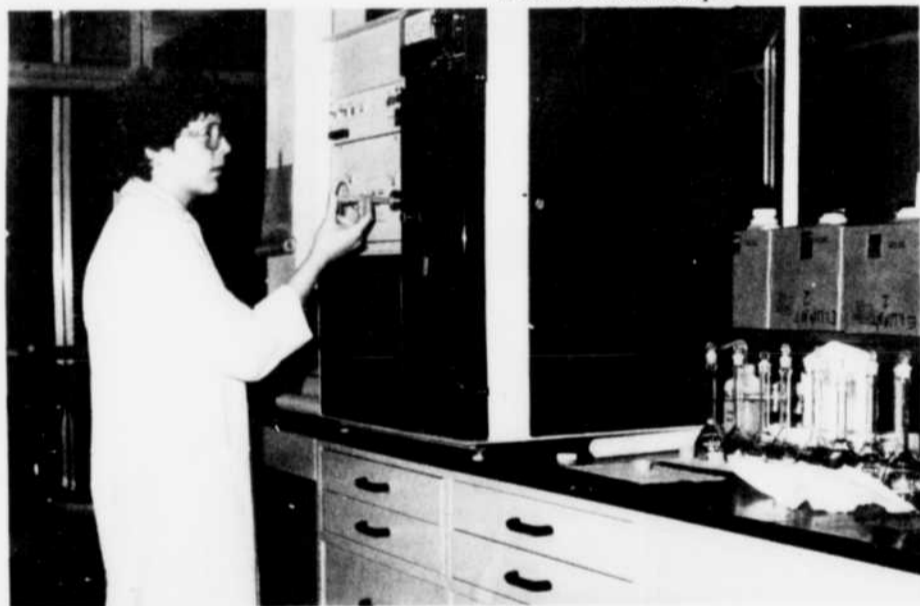
Mlle Manon Tremblay injecte un échantillon dans le chromatographe et elle obtiendra le résultat de l'analyse sur l'enregistreur dans quelques minutes.
