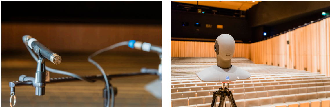
Figure 2 : Couple microphonique à gauche, tête artificielle Head-Acoustics à droite. Photos : Cyril FRESILLON / Pprime / CNRS Photothèque.
