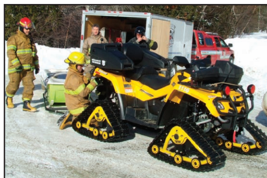
Ce véhicule tout-terrain à deux places est muni d'un système de chenilles pour la neige.
