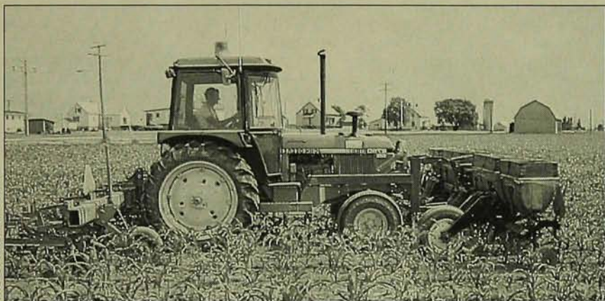
La conservation des sols oblige à repenser tout le système cultural. Ici, Michel Vermette montre le système combiné pour le sarclage et l'application d'azote.
