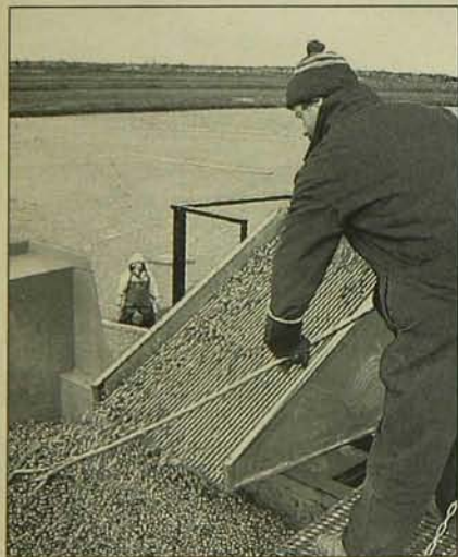
Les fruits sont acheminés par une pompe et un convoyeur jusque dans un camion.
