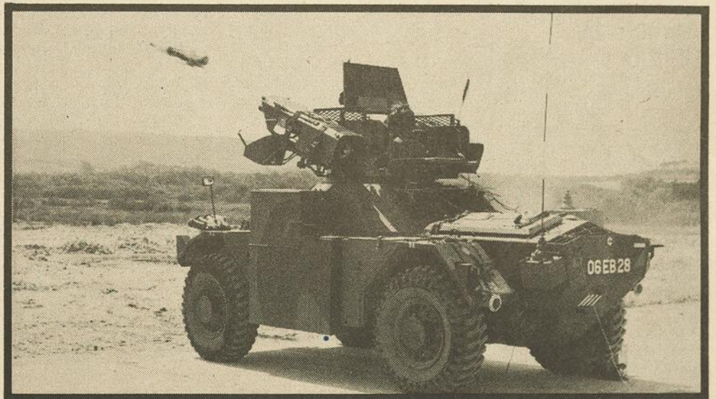
Cette photo montre un missile antichar VIGILANT, au moment de l'envol. Ce missile de portée moyenne est capable de pénétrer les plus lourds blindages jusqu'à une distance de 1375 mètres. Ce sont des missiles de ce genre qui ont servi aux guerres israëlo-arabes. Pendant la guerre du Yon Kippur, en octobre 73, ces missiles ont mis près de 3000 chars d'assaut hors de combat en dedans d'une dizaine de jours seulement. Cet événement fut une révélation.
