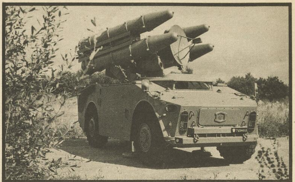
Ce système lance-missiles sol-air sert à la défense contre avions. Dans beaucoup de cas, le missile a très avantageusement remplacé le canon anti-avion. Il s'est avéré extrêmement redoutable contre les chasseurs réactés d'attaque au sol.
