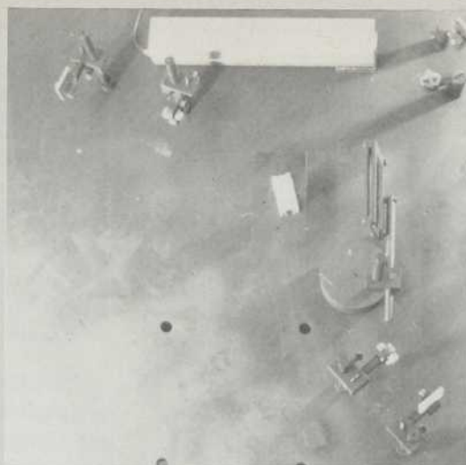
Ce montage servira à produire des hologrammes de retransmission simples. Ce type d'hologramme est réalisé par l'interférence des rayons objet et de référence à partir du même côté de la pellicule.
