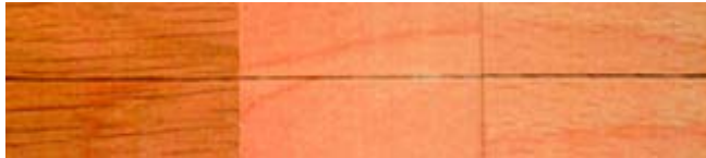
Soudage du bois sans adhésif, projet de recherche de la Haute école d'architecture, de génie civil et du bois HSB à Bienne en Suisse
