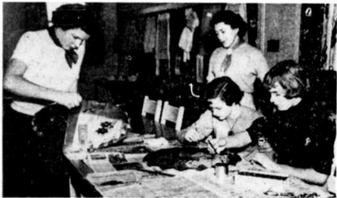
La jeune fille de gauche fait l'ondulation sur le pourtour de son cabaret pendant que les jeunes filles à droite recouvrent de peinture protectrice les parties du cabaret qui ne doivent pas être gravées.
