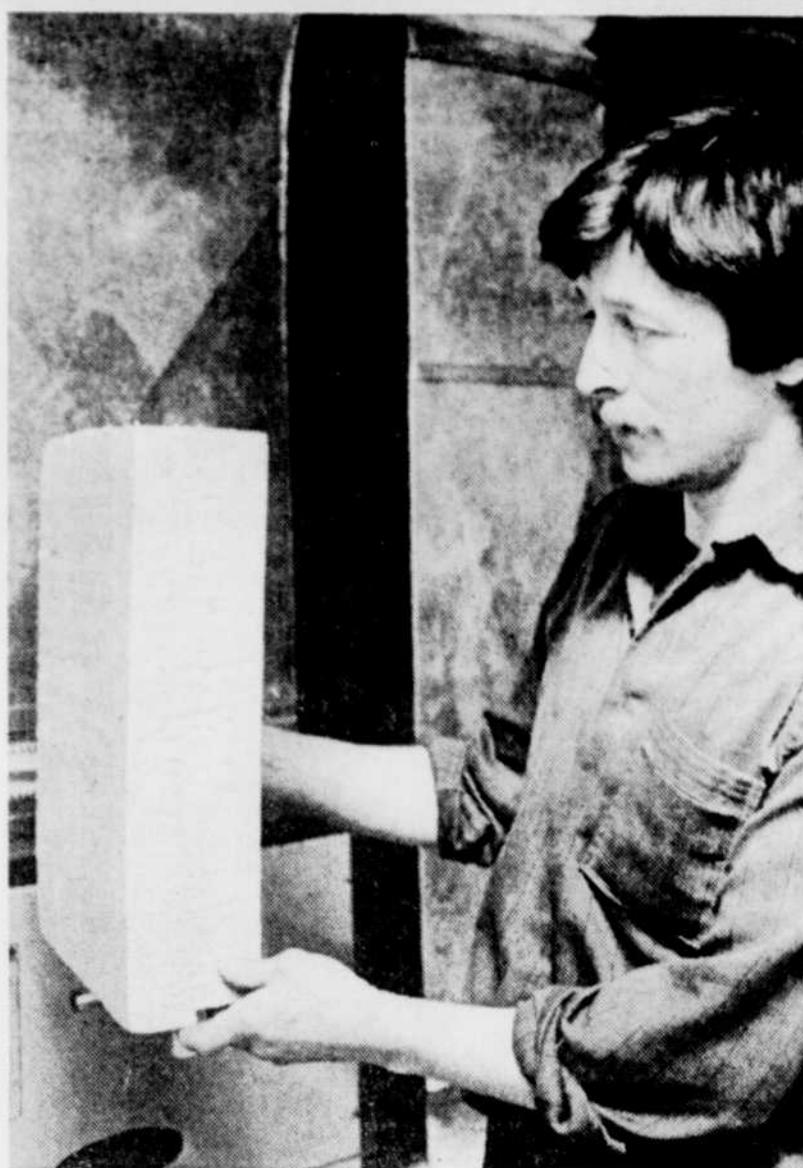
Conrad Cloutier nous montre ici un échantillon de l'isolant rigide (quatre pouces) qui recouvre les murs extérieurs des fondations de sa résidence.
