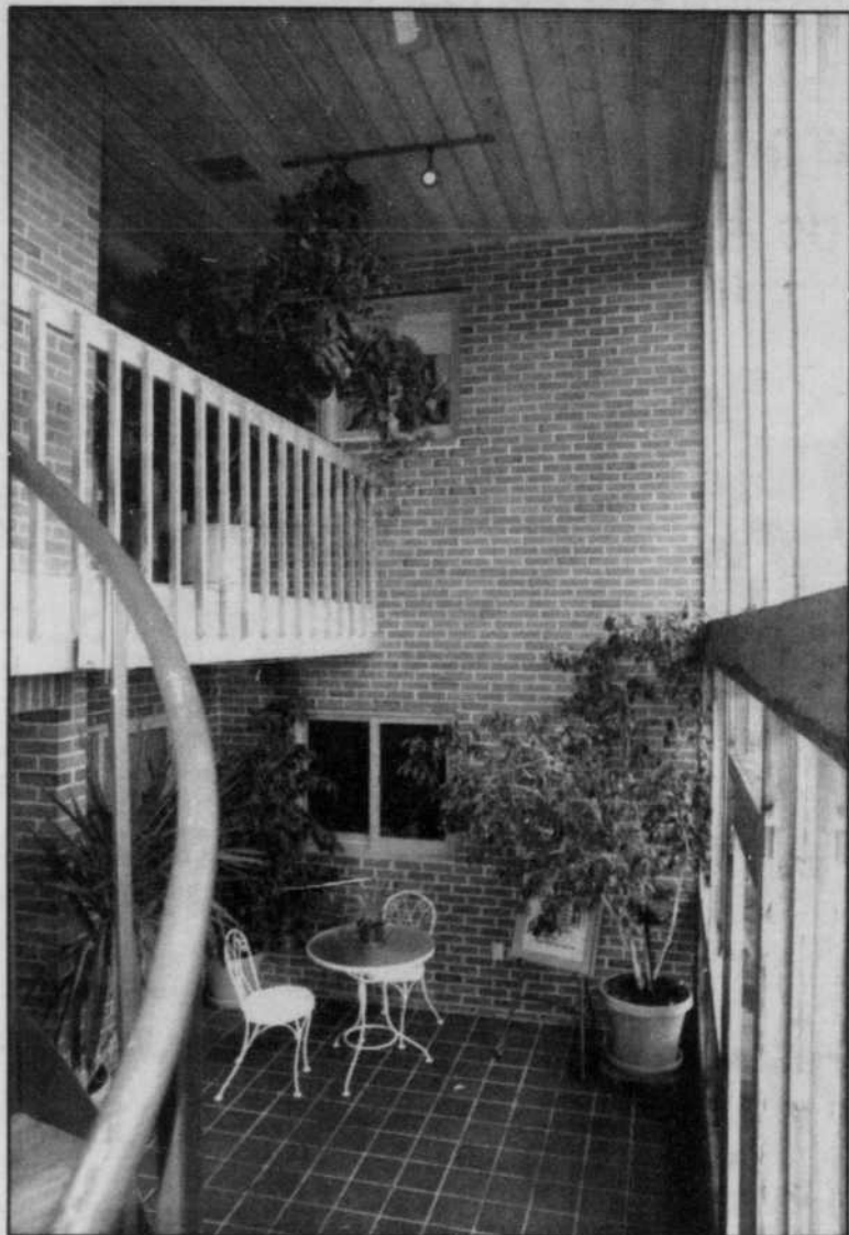
La source primaire du chauffage provient du soleil. L'énergie est captée par le solarium et chaque pièce de la maison possède une porte ou une fenêtre donnant sur cet espace.
