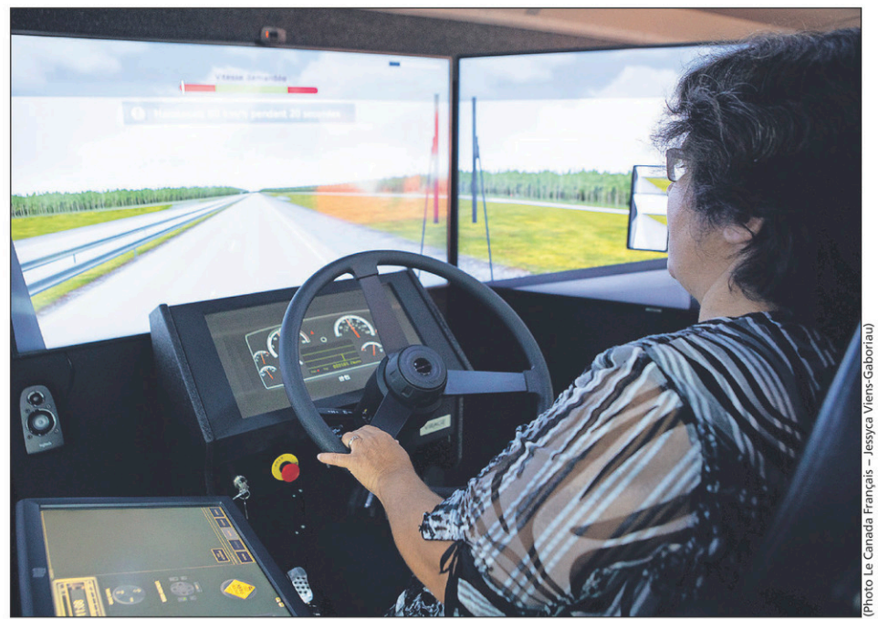
Isabelle Cantin expérimente le simulateur qui jumelle le réel et le virtuel, notamment avec ces trois grands écrans qui reproduisent le pare-brise avant et les fenêtres de côté, miroirs inclus.
