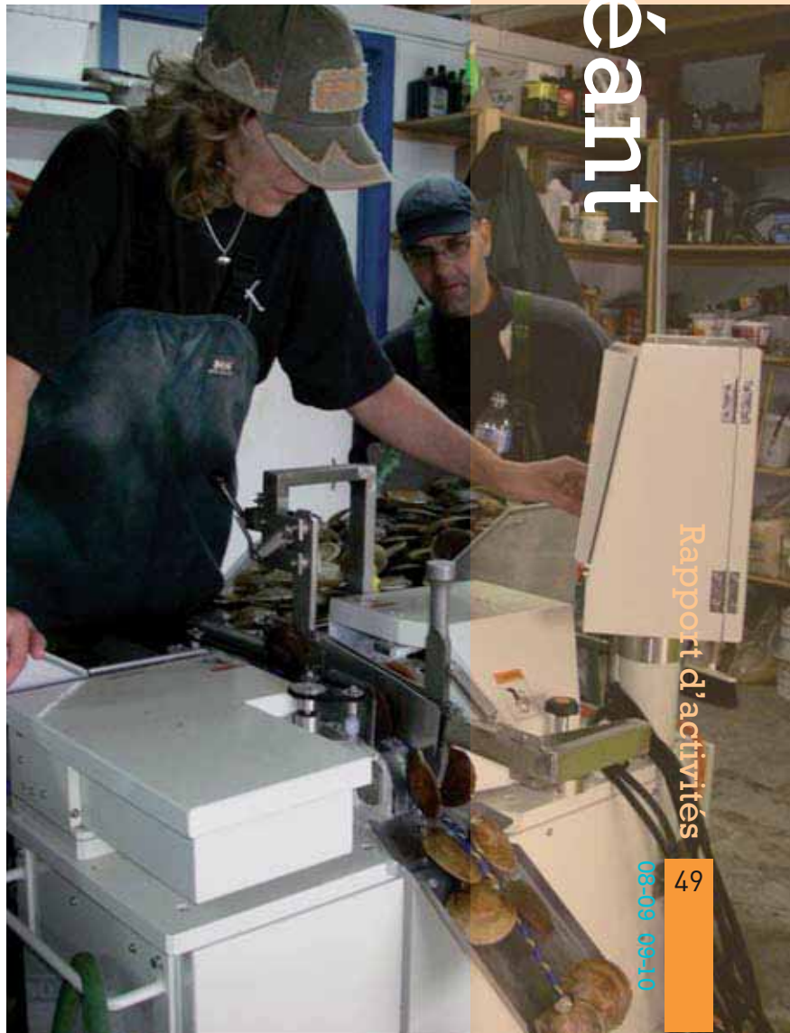
Pétoncles percés à la machine Mimitsuri.
