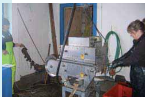
Lignes de boucles d'oreilles nettoyées à la machine.
