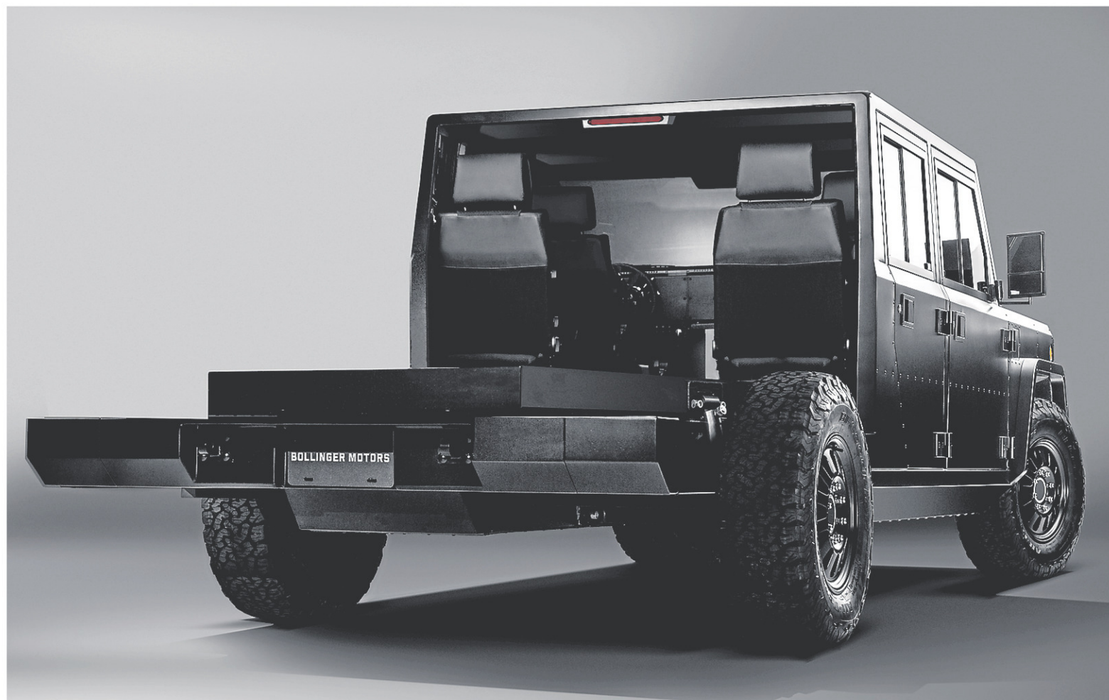
Le châssis B2CC de Bollinger Motors pourra être livré avec une cabine fermée ou une cabine ouverte à deux ou à quatre portières. Il peut être aussi ajusté selon l'empattement du véhicule. — PHOTO FOURNIE PAR BOLLINGER MOTORS
