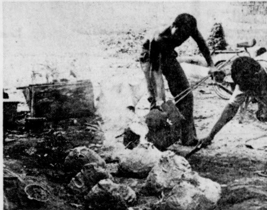
Des artisans ivoiriens coulent dans des moules de terre cuite des statuettes de bronze, au village artisanal de Grand Bassam.
