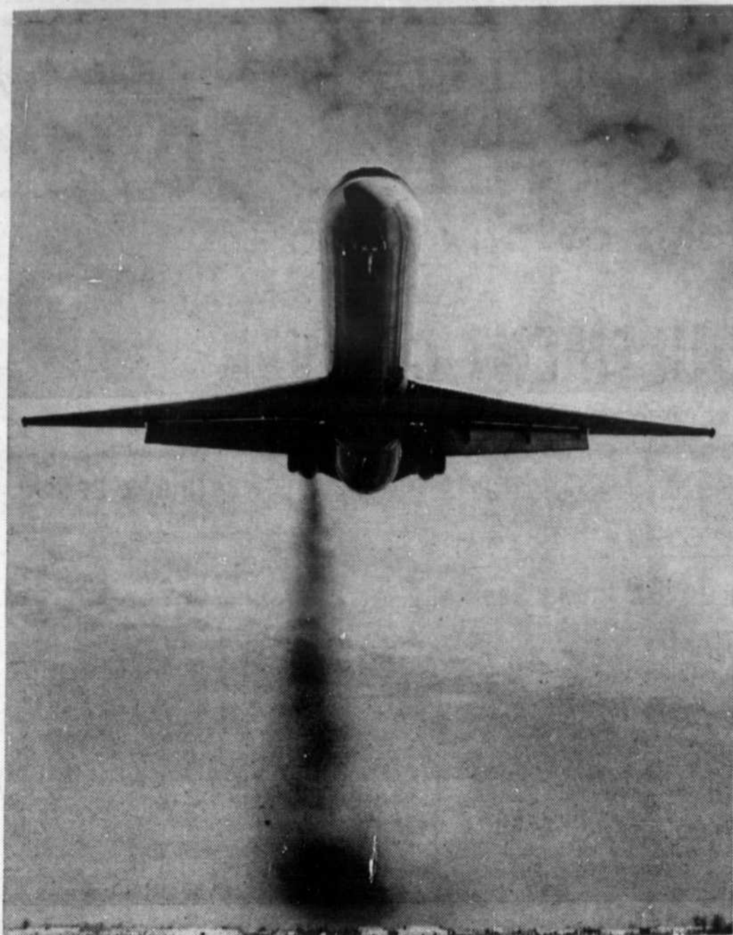
Air Canada poursuit la transformation de tous ses réacteurs Pratt & Whitney JT8D de façon à ce qu'ils ne dégagent plus de fumée. C'est de ce type de réacteur que sont équipés les 36 DC-9 de la Société. Les résultats sont illustrés ici au-dessus d'un aéroport canadien par un DC-9 dont le moteur bâbord a été transformé.
