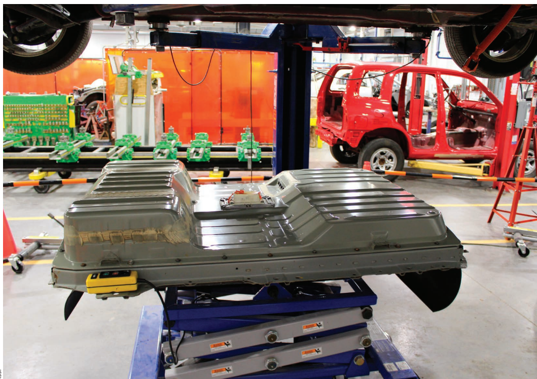
Une fois retirée, la batterie haute tension peut être déplacée grâce à la table élévatrice vers un autre endroit pour réparation ou expédition.
