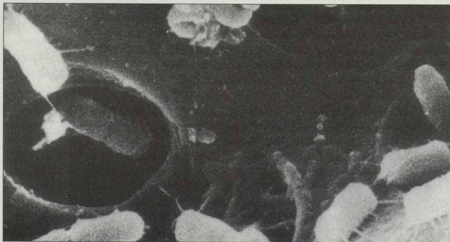
Photomicrographie montrant l'accrochage des bactéries (X 15 000) sur du schiste expansé. Ce matériau sert de milieu filtrant et de support aux bactéries, tout au cours du processus de dépollution des eaux usées par le procédé Biocarbone.
