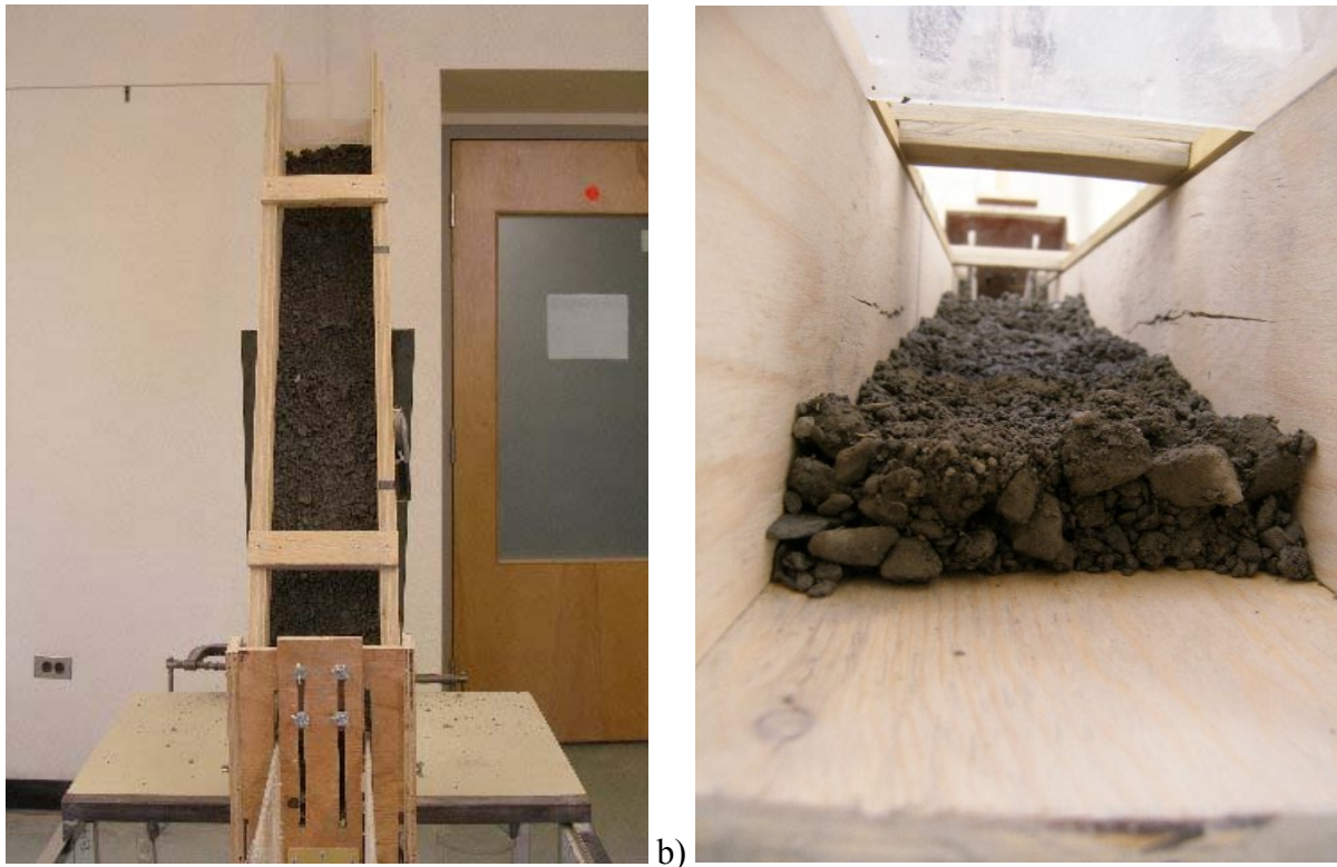
Figure 4.17. Exemple de colonne de matériau restant en place à la fin du soutirage, a) vue de face, b) vue de haut.
