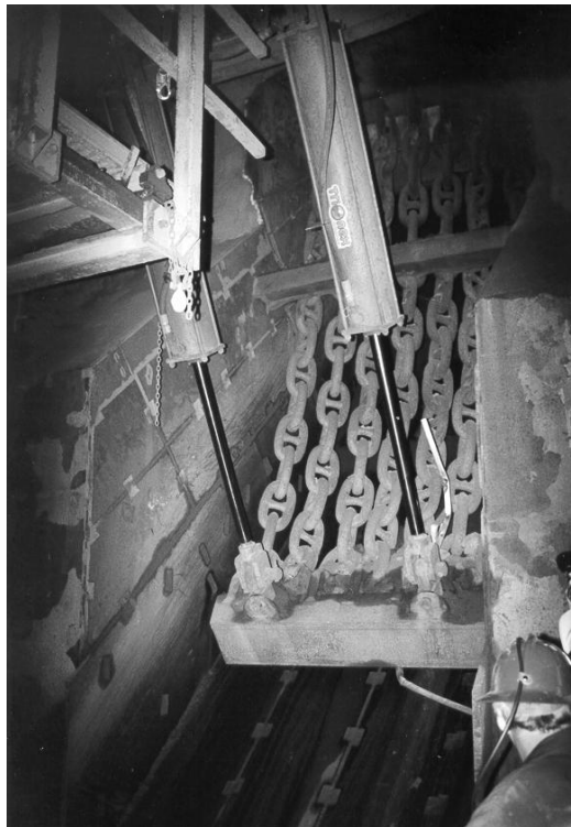
Figure 4.3. Rideau de chaînes de contrôle dans une chute, méthode d'action directe par cylindre pneumatique ou hydraulique.
