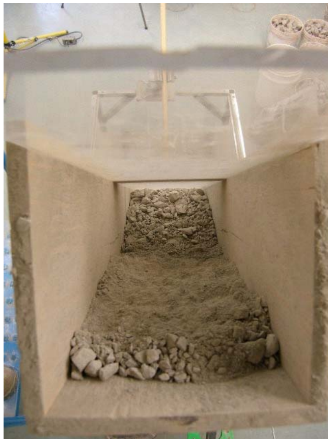
Figure 4.16. Matériau passif dans la zone d'écoulement en bouchon: matériau A, cheminée inclinée à 60^\circ après soutirage du 1er tiers.
