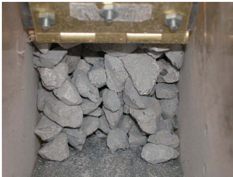
Figure 3.5. Blocage observé dans la chute, matériau B, D_0 = 10 cm, H_0 = 8 cm.
