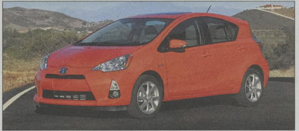
Dévoilée en 2012, la Prius c de Toyota est la moins gourmande des sous-compactes. Sa motorisation hybride combine un L4 de 1,5 litre à une batterie au nickel-métal de 144 volts.
