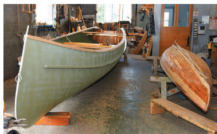
Un canot de 24 pieds et un de 14 pieds pendant le processus de remise à neuf.
