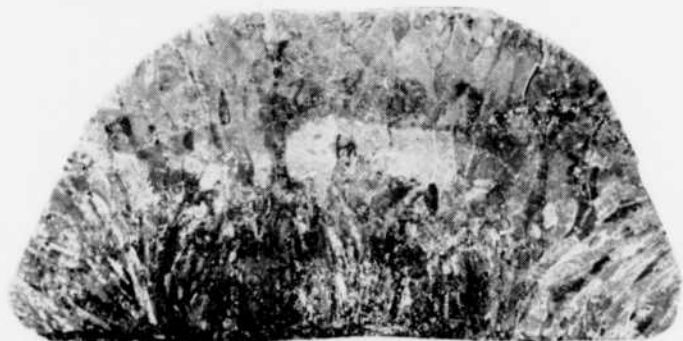
Fig. 11 — Macrostructures de coulées de titane pur et d'alliage.
