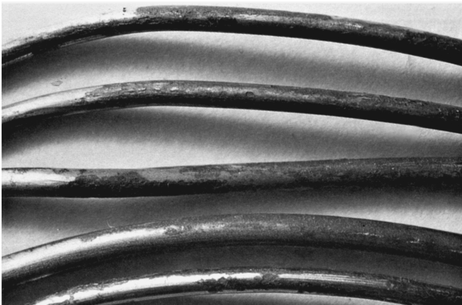
Figure A.3 — Très légère corrosion
