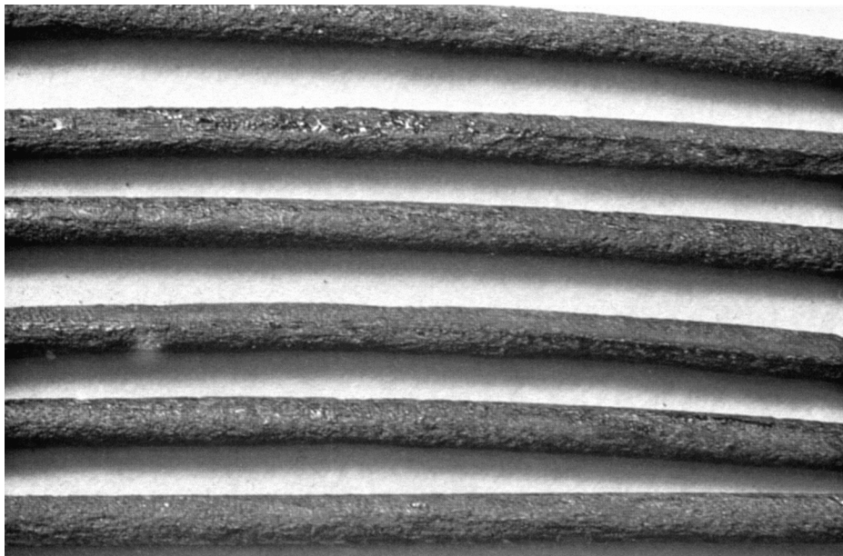
Figure A.5 — Corrosion plus que légère
