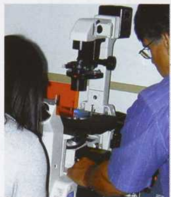
Jean-Guy Chabot, chercheur associé du Dr Quirion, et Amanada Li, étudiante à la maîtrise, examinent une section de cerveau de rat traitée à la nicotine et colorée par immunofluorescence au microscope confocal.
