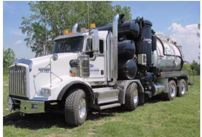
Camion Kenworth T-800, 550 hp, 12 roues, avec suspension à air relevable converti par Équipements FDS, équipement de type camion vacuum «Super-Sucker» Mastervac 3827 3800 cfm, réservoir de 11 350 l (3000 gal. US) en acier inoxydable, conçu pour aspirer pratiquement tous les types de boues qu'elle soit liquide, solide très dense ou lourde ainsi que tous les produits poussiéreux.
