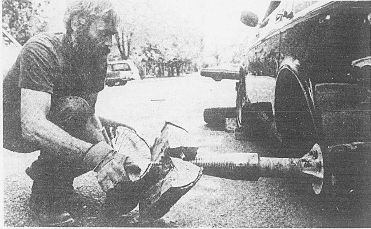
Le Stickler, qui s'adapte à un moyeu de roue, sert à fendre le bois de chauffage. Selon ses promoteurs, il permet de fendre une cordée de bois à l'heure, sans l'épuisement du travail à la hache.
