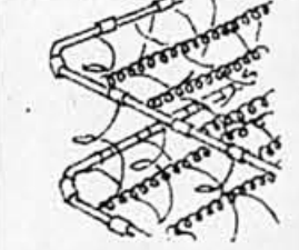
Rails de bordure renforcés donnant un meilleur support d'un bord à l'autre.
