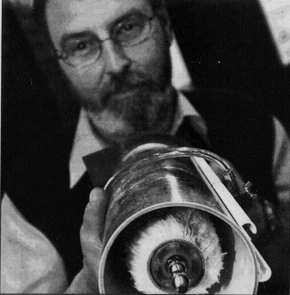
Photo Imacom, par Jocelyn Riendeau Alex Bastien en avait assez de jeter ses rouleaux de peinture au latex. La nécessité étant mère de l'invention, il a créé l'Econoroller, un appareil qui permet de laver les manchons de peinture.
