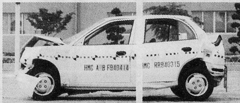
Zones déformantes avant et arrière conçues pour absorber le choc lors de collisions.
