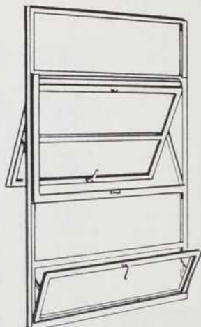
Fenêtre en Saillie Truscon en Aluminium avec Bourrelet d'Etanchéité
