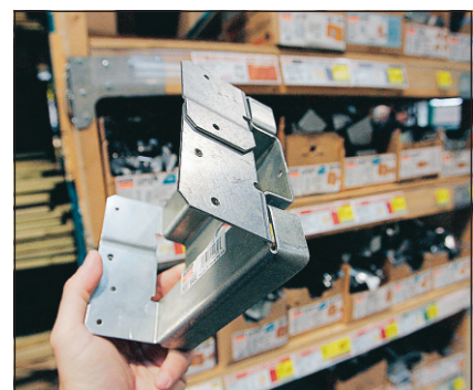
De grands fournisseurs recommandent d'utiliser ces nouveaux étriers en acier doublement galvanisé pour consolider les charpentes des terrasses traitées avec le cuivre aminé quaternaire ou l'azole de cuivre.
