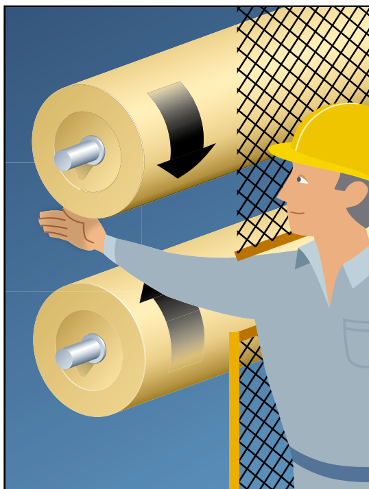
Figure 36. Prévention à l'étape de la conception pour deux cylindres sans contact
