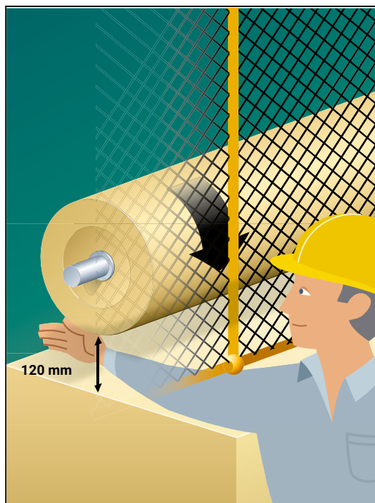
Figure 37. Prévention à l'étape de la conception pour un cylindre et une partie fixe
