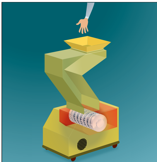
Figure 21. Broyeur de plastique muni d'une chicane
