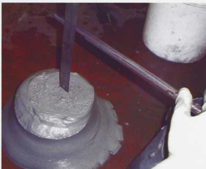
Consistance d'un remblai en pâte cimenté.
