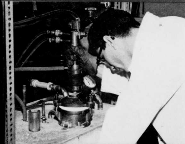
Les recherches de la Direction sur la fusion, l'alliage et le façonnage des métaux réfractaires, tels que le titane, comprennent l'étude du procédé de fusion à l'arc, sous le vide avec électrode consommable, appliqué aux alliages soumis à de hautes températures et aux aciers à usages spéciaux.
