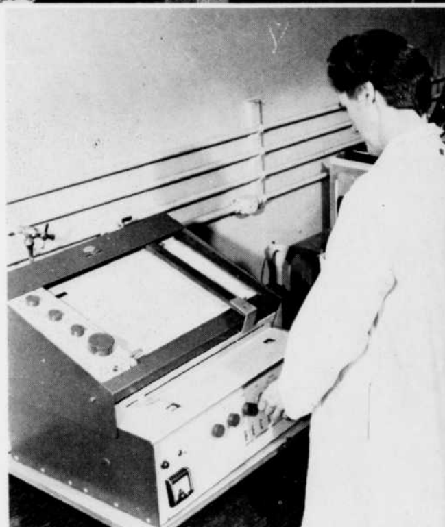
Le spectromètre à infra-rouge sert à étudier les structures chimiques des charbons, goudrons et pétroles.
