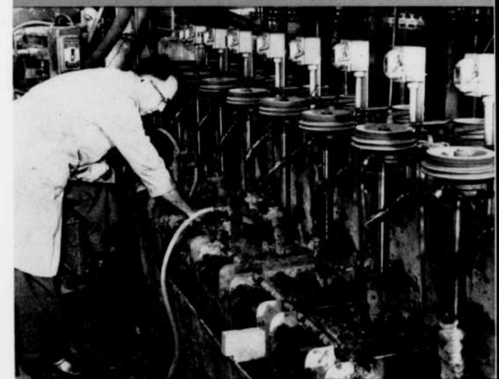
Pour enrichir les minéraux, on utilise le plus souvent la méthode de flottage par la mousse. On voit ici un technicien employant un procédé de flottage pour traiter un minerai extrait d'une mine de zinc-cuivre de l'Ouest du Québec.
