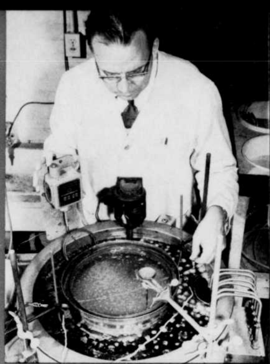
Un chercheur étudie la résistance à la corrosion du niobium en solution alcaline. On connaît assez bien sa résistance à la corrosion en présence des acides.
