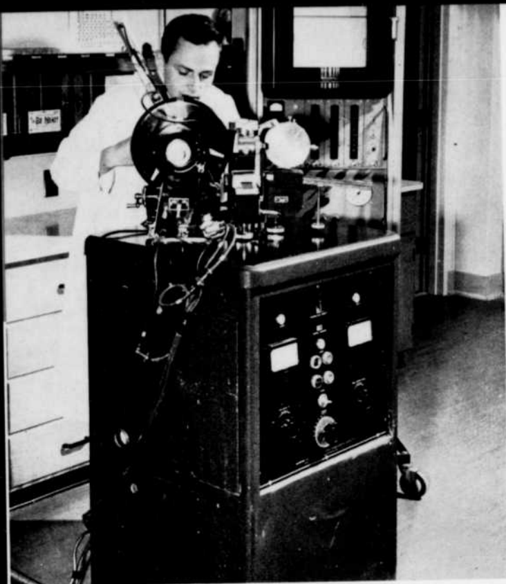
Etude de la radiodiffraction quantitative, sur un goniomètre à grand angle avec appareil enregistreur.
