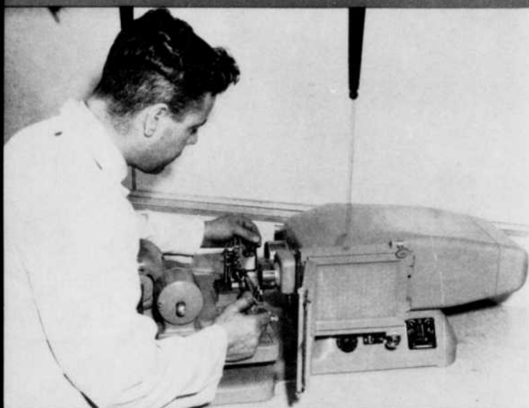
La Direction fait une étude poussée du mécanisme de la détérioration des métaux due à la fatigue. Une éprouvette est montée dans une machine de fatigue en microtorsion; le but visé est d'établir la corrélation entre les microfissures internes et la progression de la déformation plastique.
