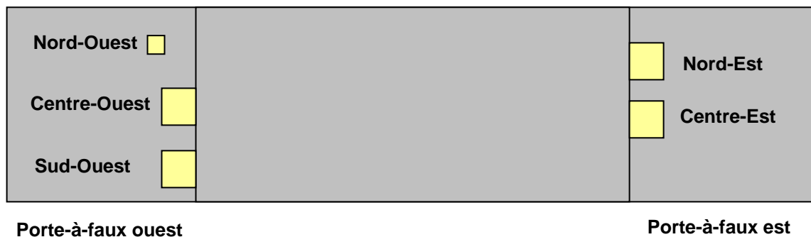
Figure 6.1 – Emplacement des fenêtres d'observation pratiquées sur la surface du viaduc de Blois
