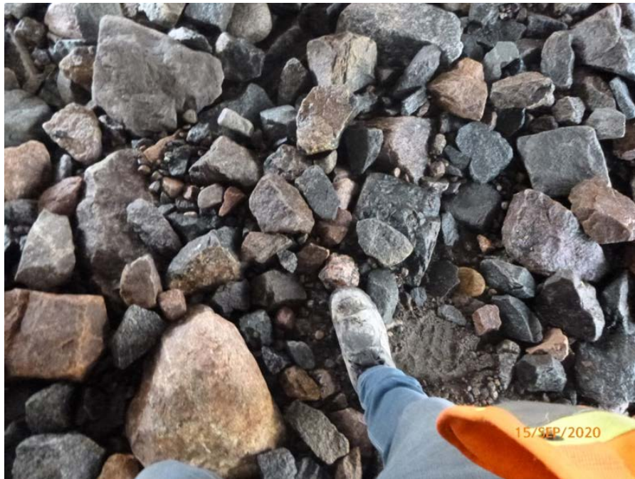
Figure 38 – Apparence du mélange granulométrique D après le lavage des matériaux de surface (MTQ)
