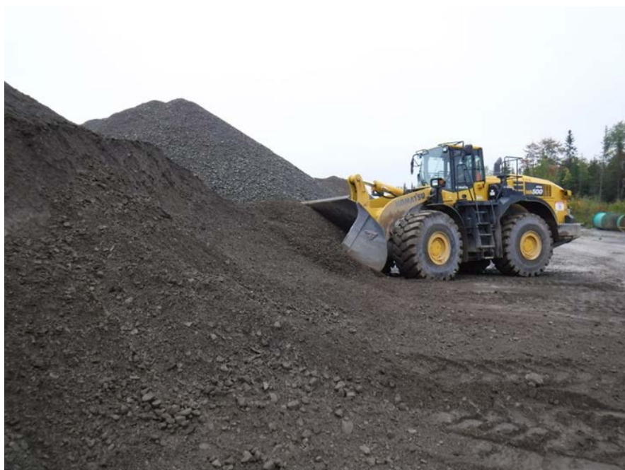
Figure 14 – Amoncellement de matériau MG 80 (MTQ)
