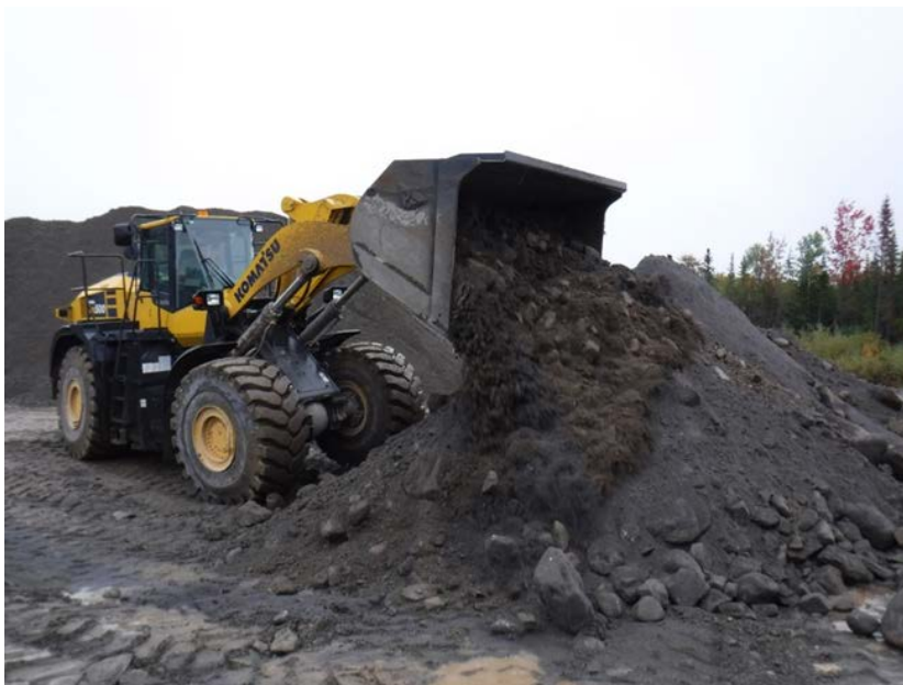
Figure 17 – Mélange des divers matériaux constituant le mélange granulométrique C (MTQ)
