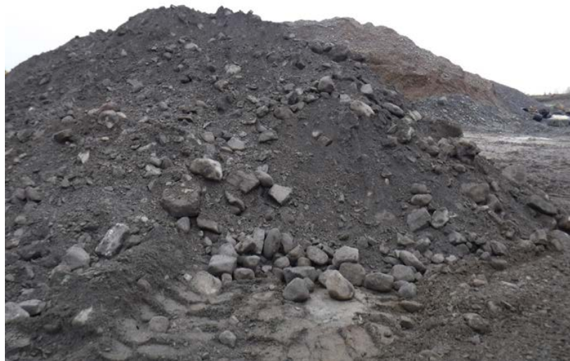
Figure 18 – Apparence du mélange granulométrique C bien mélangé (MTQ)
