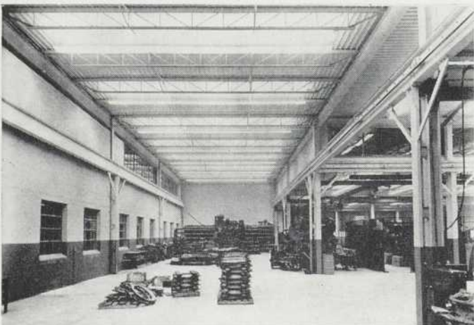
L'effet de lumière du jour obtenue des lampes fluorescentes est particulièrement bien illustré par cette section d'atelier où la lumière semble pénétrer par des fenêtres au plafond. En fait, cet atelier est illuminé par des lampes fluorescentes G-E T-12 Slimline de 92".
