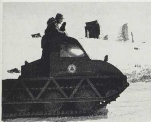
Le tracteur Bombardier, véhicule très versatile dans les régions nordiques, a été le moyen de transport utilisé durant les travaux de construction.
