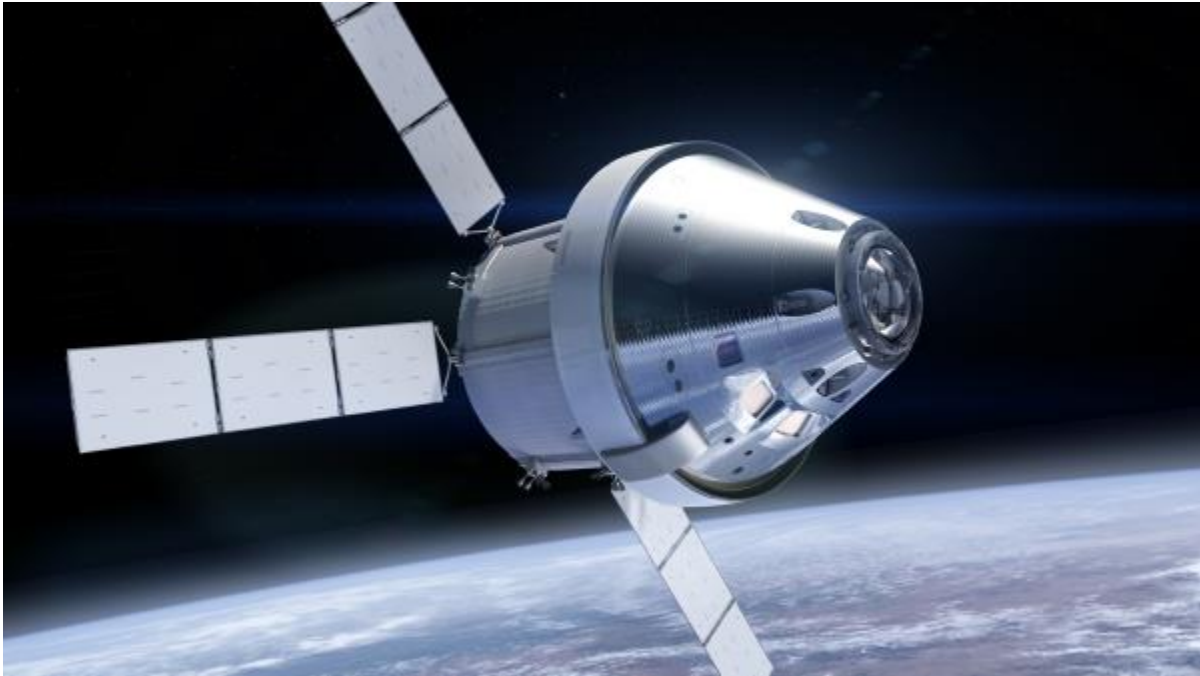
Le vaisseau Orion, composé d'une capsule (au premier plan) et d'un module de service doté de quatre panneaux solaires.
