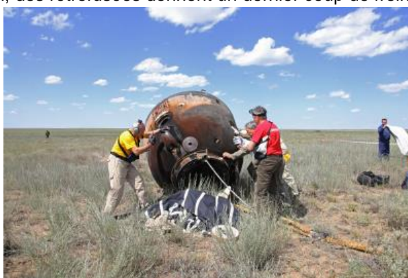
Atterrissage d'une capsule Soyouz; à un mètre du sol, des rétrofusées donnent un dernier coup de frein.
