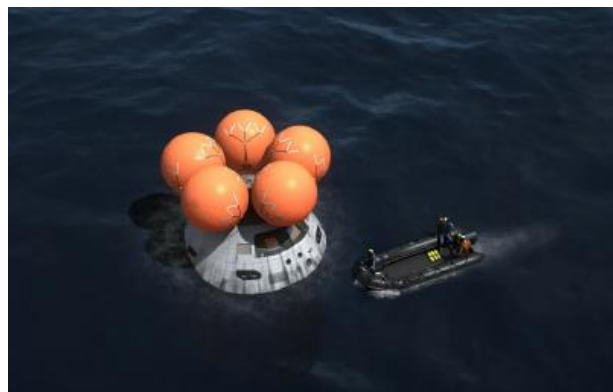
Parfois, à l'arrivée, la capsule se renverse, des ballons se gonflent alors pour la redresser.
