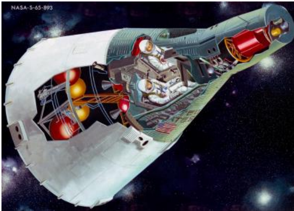
Capsule Gemini, conçue pour transporter deux astronautes, se composait de deux modules, le module de services (contenant les réserves d'oxygène, d'eau et de carburant, à gauche), et la capsule proprement dite, une «grosse» capsule Mercury.
