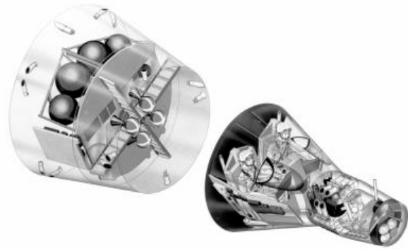
Capsule Gemini, conçue pour transporter deux astronautes, se composait de deux modules, le module de services (contenant les réserves d'oxygène, d'eau et de carburant, à gauche), et la capsule proprement dite, une «grosse» capsule Mercury.
