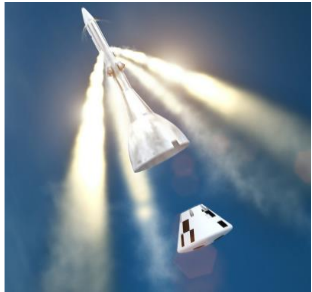
Le système de sauvetage d'une capsule Orion; la capsule ayant été propulsée à distance de la fusée
