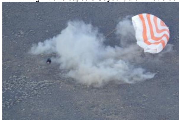
Atterrissage d'une capsule Soyouz; à un mètre du sol, des rétrofusées donnent un dernier coup de frein.
