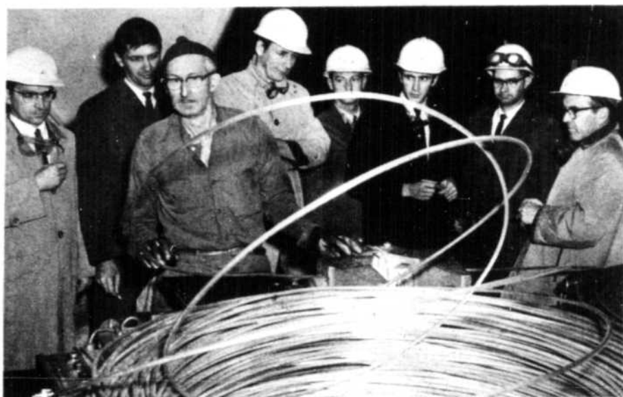
IL FAUT SOUDER LE FIL avant de l'enrouler sur les bobines géantes. Les journalistes en visite au Laminoir d'Arvida observent le soudeur effectuer cette opération. Dans l'ordre habituel, MM. Roch Desgagné, du Progrès-Dimanche, Guy Robin, surintendant du Laminoir, Jos Gaudreault, opérateur au Laminoir, Ronald Lévesque, de CJMT, Charles Legendre, de CJPM, Roger Leroux, du Soleil, Claude Lamy, ingénieur à la production, à l'usine de coulage no 4, ainsi que J.J. Marier, du Lingot.
