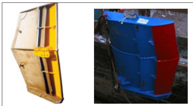
Figure 11 : Exemples de portes en forme de « V » et munies de fentes. À gauche, Morgère Wx, à droite, Poly-Ice El Cazador.
