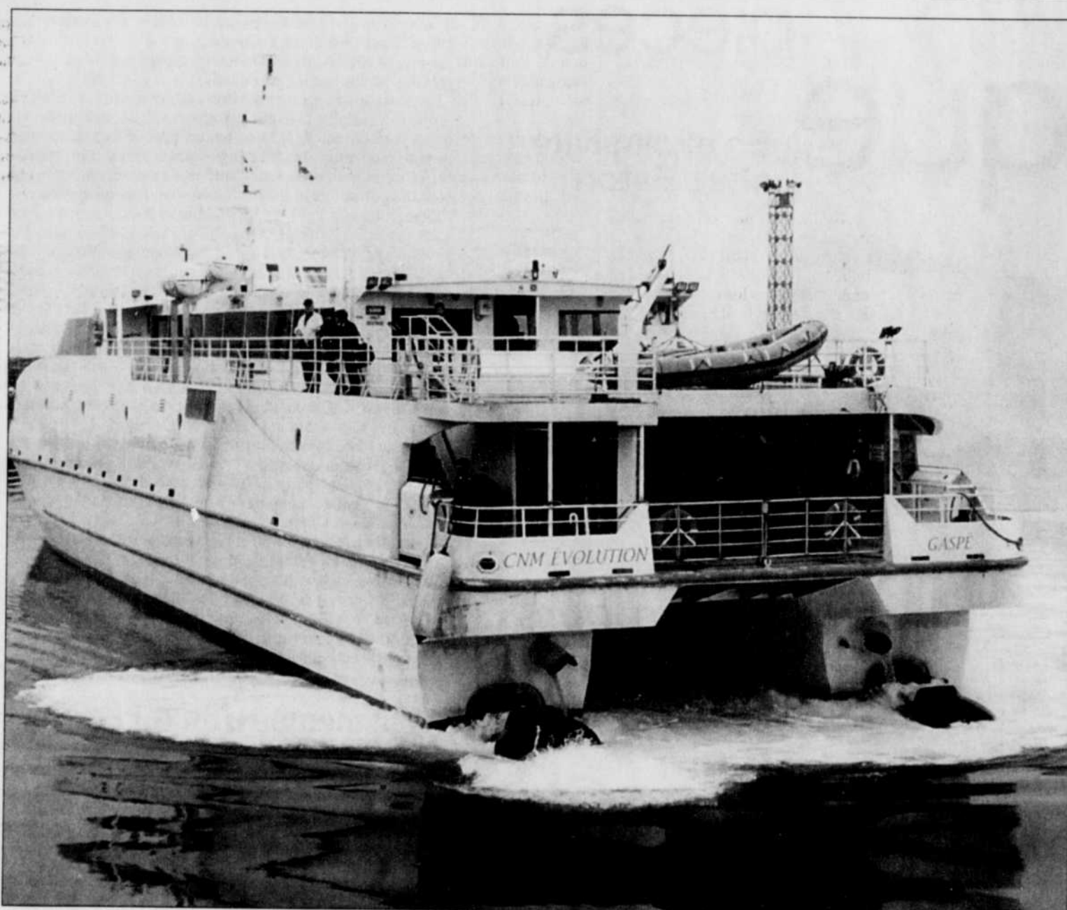
Le traversier-catamaran C.N.M. Evolution qui relie Rimouski à Forestville en 55 minutes a pour port d'attache Rimouski-Est. Avec ses deux moteurs de 2600 forces, il est le plus rapide au Québec.
